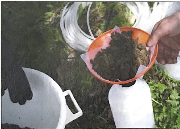
Насыпание почвы поверх кварцевого дренажа в лизиметре перед установкой в грунт. Фото Н.Поликарпова. Covering the quartz drainage layer in a lysimeter with soil before burying the device. Photo N. Polikarpova
