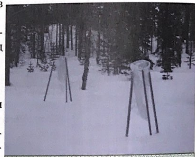
Общий вид установленных снегоприемников. Фото Н.Поликарпова. General appearance of snow gauges in operation. Photo N. Polikarpova.
